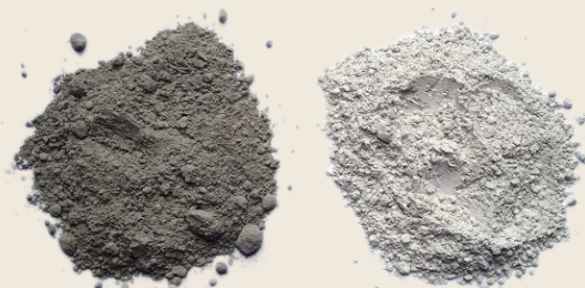
Spoiwa z trassem Optosan jako jedyne na rynku są w kolorze starej bieli. Po lewej wapno hydrauliczne HL 5, po prawej Optosan TrassKalk.
